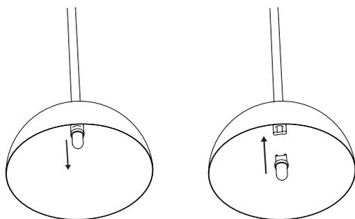
Insérer la source lumineuse dans le culot.
