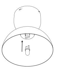
Insérer la source lumineuse dans le culot.
