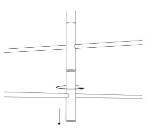
De bas en haut, écarter le bloc et pivoter jusqu'à mise en place.
