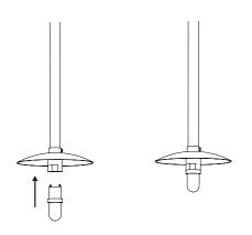
Insérer la source lumineuse dans le culot.
