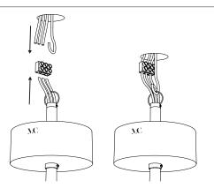
Connecter les fils au réseau électrique après avoir installé le crochet.
