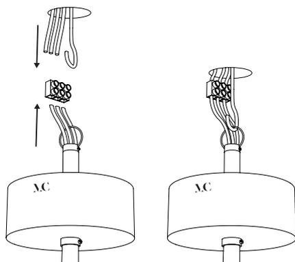
Connecter les fils au réseau électrique après avoir installé le crochet.
