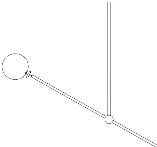
Installer la sphère en laiton sur le tube fileté.
