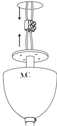
Connecter les fils au réseau électrique.
