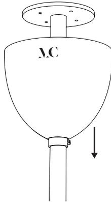
Descendre le cache-fil sur le tube après avoir dévissé la vis de la bague.
