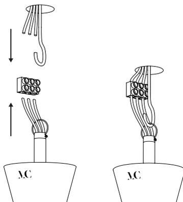
Connecter les fils au réseau électrique après avoir installé le crochet.
