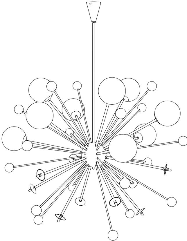
Installer les ampoules et les sphères en verre sur la partie supérieure du lustre.
