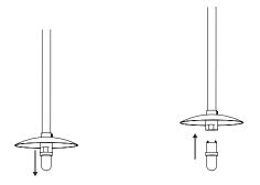
Insérer la source lumineuse dans le culot.
