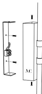
Placer la platine au mur avec des chevilles.
