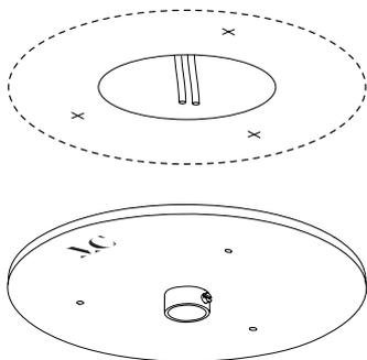
Au crayon, tracer les repères au plafond grâce à la platine.
