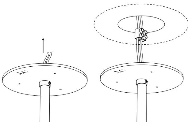
Connecter les fils au réseau électrique.
