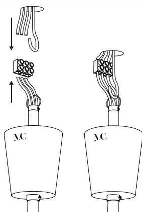
Connecter les fils au réseau électrique après avoir installé le crochet.
