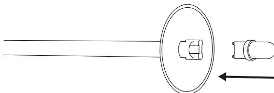
Pour les sources lumineuses, insérer la source lumineuse dans le culot.
